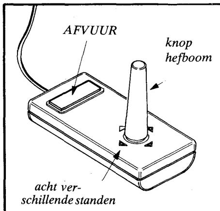
Beide met de hand bediende boxen hebben twee bedienings-organen, de hefboom en de AFVUURknop. De vier merk-punten aan de onderkant van de hefboom geven vier standen
