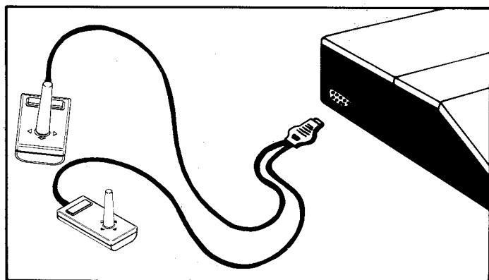
Le connecteur peut être branché à n'importe quel moment sans déranger l'exécution des programmes en cours. Certaines applications nécessitent l'utilisation des deux manettes alors que d'autres n'en nécessitent qu'une seule.
