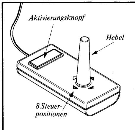
Jede Einheit verfügt über zwei Steuerfunktionen, den Hebel und den Aktivierungsknopf. Die 4 Markierungen um den Hebel geben die 4 Haupthebelpositionen an, die neben der Zentralposition und den 4 Diagonalpositionen möglich sind.
