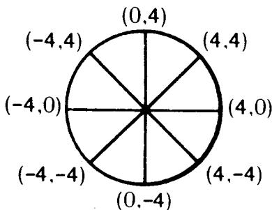
Bei Durchführung des Statements CALL JOYST werden den X- und Y-Rückgaben aufgrund der Hebelposition automatisch ganzzahlige Werte von -4, +4 oder 0 zugeordnet.
