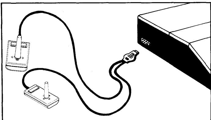
Het snoer kan elk gewenst moment ingestoken worden zonder dat de gebruikte module of het TI BASIC programma verstoord worden. Sommige toepassingen hebben beide boxen nodig, terwijl andere activiteiten er maar één gebruiken. Wanneer de ALPHA LOCK toets gedrukt is, kan het zijn dat de afstandbediening niet goed funktioneert.
